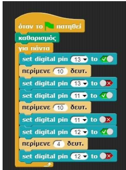
Σχήμα 5 : Κώδικας λειτουργίας φωτεινού σηματοδότη στο Snap 4 Arduino.
