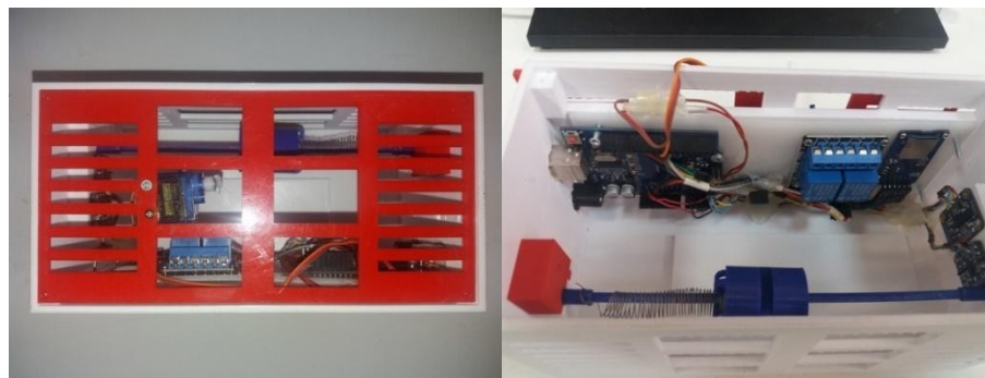
Σχήμα 8: Τελική κατασκευή του NanoLab. Αριστερά: top view με κλειστό το κάλυμμα πάνω στο οποίο είναι συνδεδεμένο το servomotor για τον έλεγχο του ελατηρίου. Δεξιά: το εσωτερικό του NanoLab
