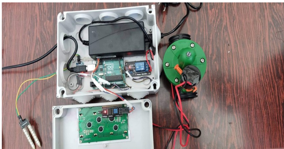
Σχήμα 5: Σύστημα Αυτόματου Ποτίσματος με Arduino
