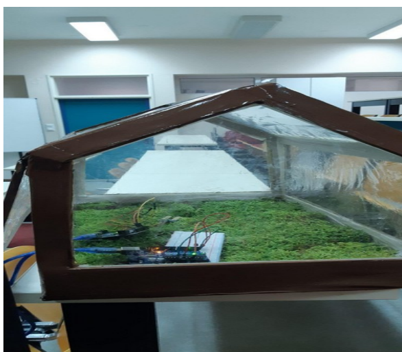
Σχήμα 5: Το θερμοκήπιο με τους αισθητήρες θερμοκρασίας και υγρασίας.
