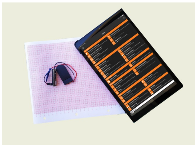
Σχήμα5: Ολοκληρωμένο σύστημα Phyphox- Arduino sense (με μπαταρίες).
